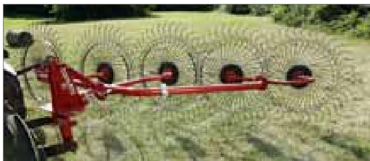
Ruote stellari montate su braccio oscillante
