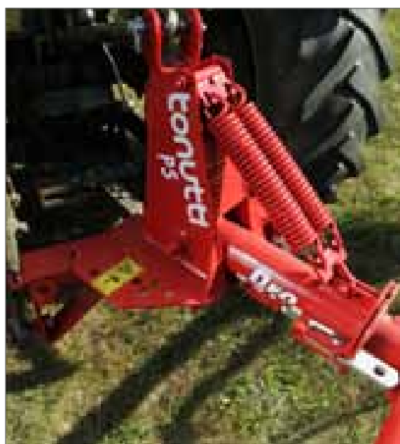
Testa di attacco al trattore con molle ammortizzatrici
