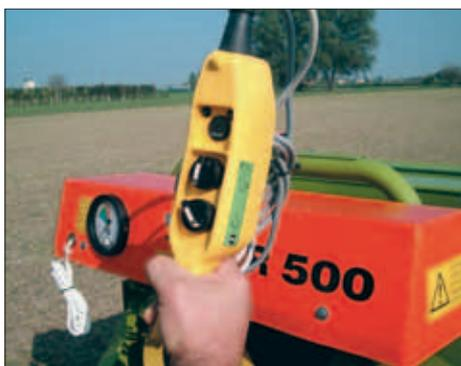
Una pulsantiera elettrica consente l'esecuzione di tutte le funzioni direttamente dalla trattrice (A= apertura-chiusura portellone, B= salita-discesa pick-up) e con grande semplicità. Inoltre, direttamente sulla pulsantiera è posizionato il cicalino d'avviso di balla ultimata e contaballe.
