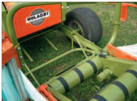
Il sistema di fasciatura è a 2 bracci rotanti con 2 stirafilmi, per garantire un avvolgimento rapido e perfetto; il taglio film è eseguito dai 2 coltelli idraulici.
