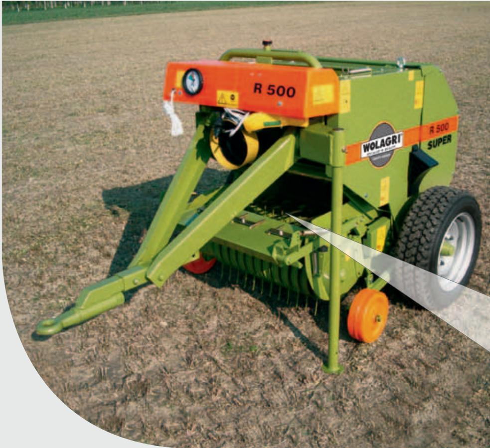
Il modello SUPER si differenzia nell'adozione di un infaldatore rotativo che ha il compito di prelevare il foraggio dopo il pick-up e di introdurlo direttamente nella camera di compressione, ottenendounaballapiùcompatta. Questa versione consente di ottenere grossi vantaggi nella raccolta di prodotti lunghi e su andane grandi. La macchina monta di serie due ruote pk in ferro.
