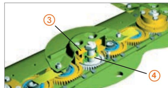
Le POLARIS sono tutte dotate di sgancio di sicurezza "Non-Stop", con il quale è possibile continuare a tagliare senza dover fermare la trattoria e senza arretrare dopo aver trovato un ostacolo. Il riaggancio avviene in maniera totalmente automatica, senza l'intervento né dell'operatore né di componenti idraulici, aumentando la durata della macchina.
